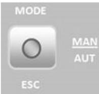
a) Botón para cambiar de modo manual, automático y para salir de los menús (ESC).
